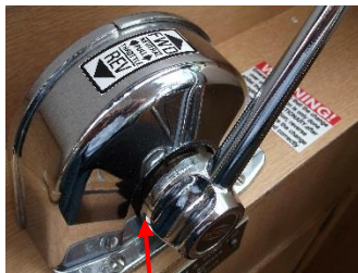
Tirer vers l'avant pour charger batteries et chauffer l'eau / Pull out and rev forward to charge batteries & heat water / Rausziehen und vorwärts um Batteri zu laden und fuer heisses wasser
