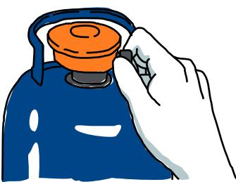
Se si sente odore di gas all'interno della barca, spegnete tutte le fiamme libere, chiudete il gas al serbatoio, ventilate la barca, spegnete i cellulari e, quando possibile, lasciate la barca. Una volta a terra, i telefoni cellulari possono essere riaccesi per contattare la base non appena possibile. Il gas deve essere chiuso al serbatoio durante la notte o quando non è utilizzato.
