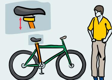
Se avete prenotato delle biciclette, prima di lasciare la base dovete controllare che le posizioni di guida siano adatte a tutto l'equipaggio. Per motivi di sicurezza è importante che l'altezza della sella sia regolata correttamente per ogni ciclista; c'è una posizione alta e una bassa che non deve essere superata e se non è nella posizione corretta potrebbe verificarsi un incidente. Le biciclette sono dotate di luci, quindi assicuratevi che funzionino correttamente prima di lasciare la base.
