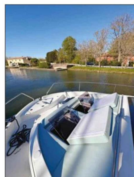
Les matelas avant sont découpés de manière à ce que les panneaux ouvrants restent fonctionnels.
