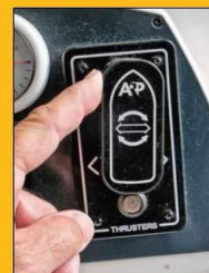
La commande de propulseurs avant et arrière est particulièrement intuitive et elle autorise un déplacement latéral, pratique le long d'un quai encombré.
